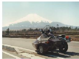
27歳 6台目のカーはGL500用に設計製作。ボディーはFRP製フロントスクリーン・トランクは開閉式、カー側ブレーキは後輪と連動にした。補助燃料タンクも作り電磁ポンプで送るシステムでした。フロントサスペンションはアールズフォークに初めて挑戦。アライメントについて多くのデータを得ることができました。
